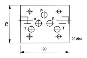
Messzwischenplatte G1/4" Anschluss in A und B
